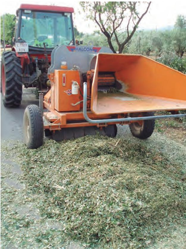
**Figura 3.** Maquinaria para el picado de los restos de poda de los cítricos, para su posterior aplicación en el centro de las calles del cultivo.
