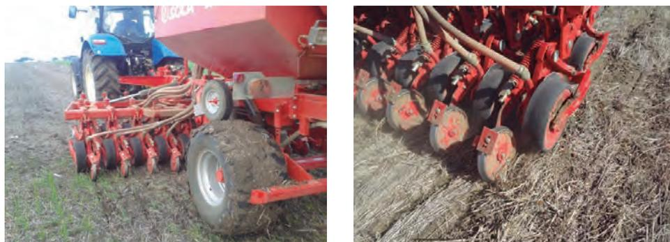
**Figura 5.** Detalle del trabajo de una sembradora de siembra directa.
